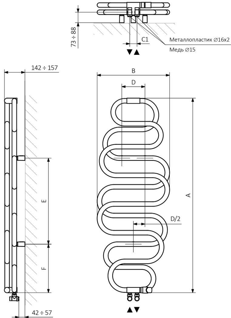
A – высота B – ширина C1-C5 – расстояние между осями подключения D – расстояние между осями крепежей по горизонтали E – расстояние между осями крепежей по вертикали F – расстояние от оси нижнего крепежа до нижнего края коллектора
