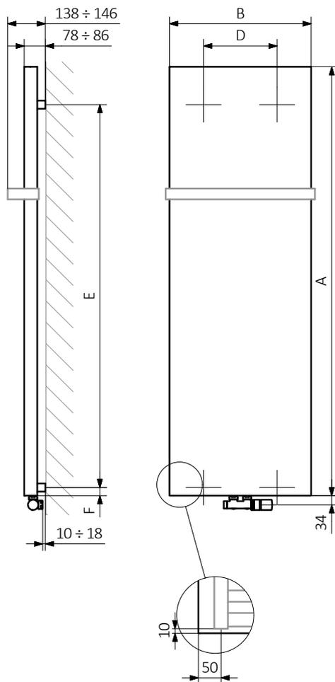
A – высота B – ширина C1-C5 – расстояние между осями подключения D – расстояние между осями крепежей по горизонтали E – расстояние между осями крепежей по вертикали F – расстояние от оси нижнего крепежа до нижнего края коллектора
